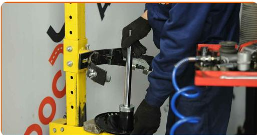
**52** Installieren Sie die Feder am Stoßdämpfer.
