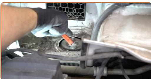
**40** Lösen Sie die obere Befestigung des Domlagers. Verwenden Sie Ring-Gabelschlüssel Nr. 21. Verwenden Sie Inbusschlüssel Nr. H7. Verwenden Sie einen Ratschenschlüssel.
