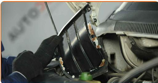
**38** Entfernen Sie die Kappe des Federbeinstützlagers. Benutzen Sie ein Brecheisen.
