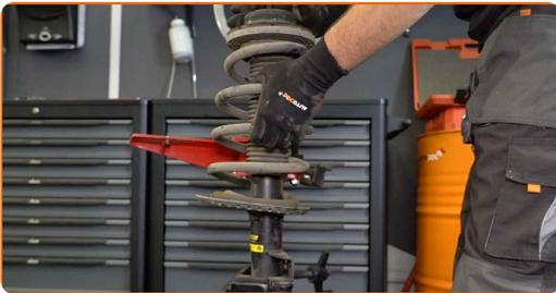
Austausch: Federbein – VW Transporter V Bus (7HB, 7HJ, 7EB, 7EJ, 7EF, 7EG, 7HF, 7EC). Tipp von AUTODOC:
