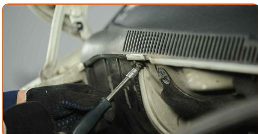
**37** Entfernen Sie die Schutzabdeckung.
