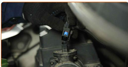
**30** Lösen Sie die Befestigungsclips der Luftfilterabdeckung.
