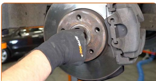
**93** Die Antriebswellenmutter festziehen. Verwenden Sie Stecknuss Nr. 30. Verwenden Sie einen Drehmomentschlüssel. Ziehen Sie ihn mit 200 Nm Drehmoment fest.
