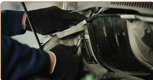
**67** Bauen Sie die Dichtung der Windabweiserabdeckung ein.
