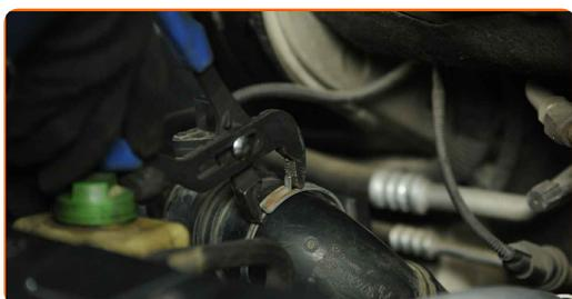
**32** Trennen Sie das Luftansaugrohr vom Luftfilter-Gehäuse.
