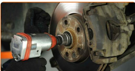
**17** Entfernen Sie die Befestigungsmutter.
