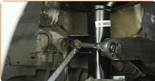
**90** Bauen Sie den Spurstangenkopf an dem Achsschenkel an.
