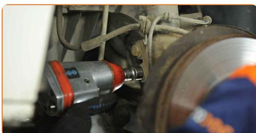
**22** Entfernen Sie die Befestigungsschrauben.
