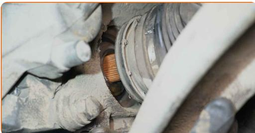
**83** Verbinden Sie das Kugelgelenk mit dem Achsschenkel.
