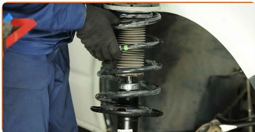
**62** Schrauben Sie die obere Befestigung des Domlagers an.
