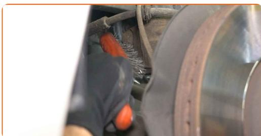
**21** Schrauben Sie die Befestigungen ab, die das Federbein mit dem Achsschenkel verbinden. Verwenden Sie Stecknuss Nr. 18. Verwenden Sie einen Ratschenschlüssel.
