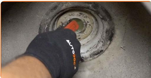
**61** Installieren Sie das Federbein am Radlauf.
