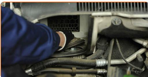
**39** Reinigen Sie die obere Befestigung des Federbeinlagers. Benutzen Sie eine Drahtbürste. Benutzen Sie WD-40-Spray.
