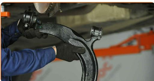
**Austausch: vorderer unterer Lenker – VW Transporter V Bus (7HB, 7HJ, 7EB, 7EJ, 7EF, 7EG, 7HF, 7EC). Fachleute empfehlen:**
