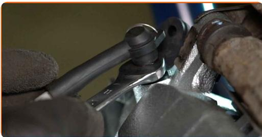
**31** Trennen Sie den Schlauch des Bremsentlüftungs-Kits.
