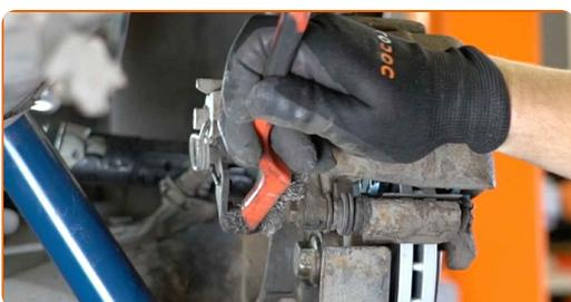
**12** Reinigen Sie den Bereich, in welchem der Bremsschlauch an den Bremssattel angeschlossen ist, sowie den Bereich der Führungsbolzen. Verwenden Sie eine Nylon-Reinigungsbürste. Benutzen Sie einen Bremsenreiniger.
