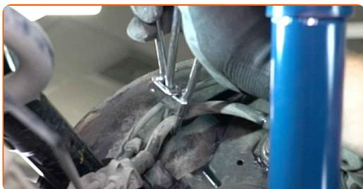
**15** Schrauben Sie die Befestigung des Bremssattels ab. Verwenden Sie Stecknuss Nr. 12. Verwenden Sie einen Ratschenschlüssel.
