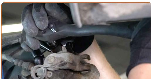
**16** Entfernen Sie den Bremssattel.
