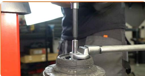
**52** Dekomprimieren Sie die Feder.
