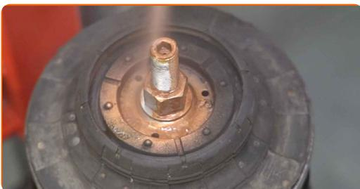
**55** Reinigen Sie die Anbringungssitze des Federbeins. Benutzen Sie eine Drahtbürste. Benutzen Sie WD-40-Spray.
