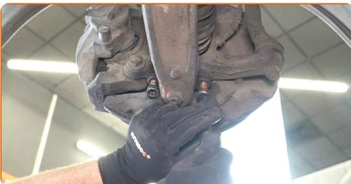
**67** Ziehen Sie das Befestigungselement fest, das das Traggelenk mit dem Achsschenkel verbindet. Benutzen Sie den XZN #14. Verwenden Sie einen Drehmomentschlüssel. Ziehen Sie ihn mit 90 Nm Drehmoment fest.+45°
