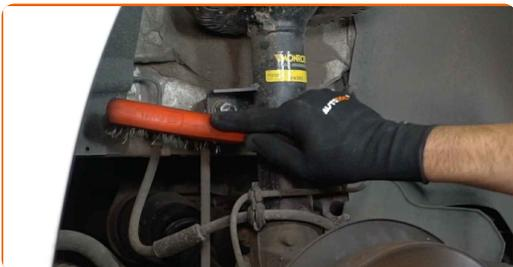
**20** Schrauben Sie das Befestigungselement heraus, das die Druckstange mit dem Federbein verbindet. Verwenden Sie Stecknuss Nr. 18. Verwenden Sie einen Ratschenschlüssel.
