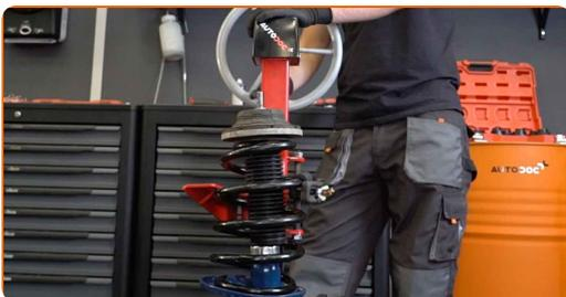
**53** Entfernen Sie das zusammengebaute Federbein.
