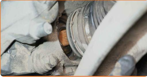
**64** Entfernen Sie den Träger unter dem Achsschenkel.
