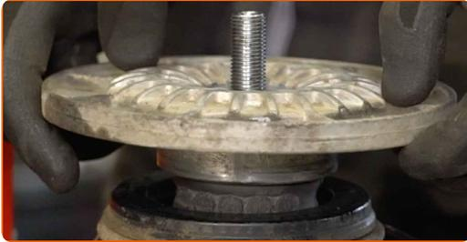
**51** Ziehen Sie die Federbeinkolbenstangenmutter an. Verwenden Sie Stecknuss Nr. 21. Verwenden Sie Inbusschlüssel Nr. H7. Verwenden Sie einen Drehmomentschlüssel. Ziehen Sie ihn mit 80 Nm Drehmoment fest.
