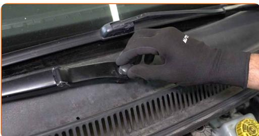
**91** Entfernen Sie die Kotflügel-Abdeckung.
