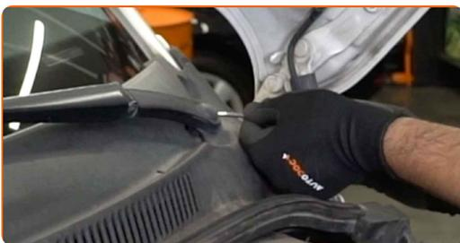
**4** Reinigen Sie die Befestigungen der Wischerarme. Benutzen Sie eine Drahtbürste. Benutzen Sie WD-40-Spray.
