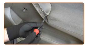
Lösen Sie den Hebel zur Einstellung des Außenspiegels.
