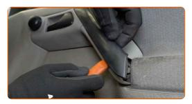
Schrauben Sie die Befestigung des Türgriffs ab. Verwenden Sie einen Kreuzschlitzschraubendreher.
