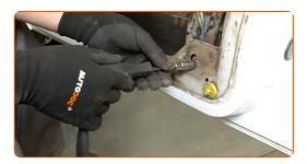
Entfernen Sie den Fensterhebermechanismus.
