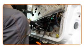
Ziehen Sie die Befestigungselemente der Fensterheberbaugruppe fest. Verwenden Sie Stecknuss Nr. 10. Verwenden Sie einen Drehmomentschlüssel. Ziehen Sie ihn mit 10 Nm Drehmoment fest.
