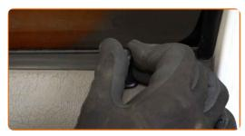
Schrauben Sie die Türgriffbefestigung ein. Verwenden Sie einen Kreuzschlitzschraubendreher.
