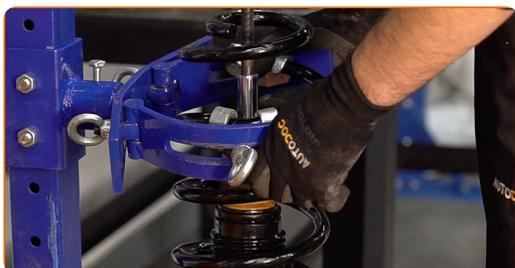
**42** Bauen Sie das Domlager und das Federbeinstützlager ein. Benutzen Sie ein Brecheisen.
