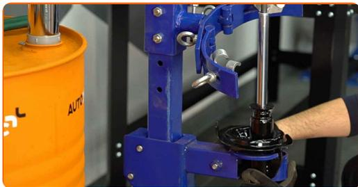
**39** Installieren Sie die Staubschutzmanschette und den Anschlagpuffer auf dem neuen Stoßdämpfer.
