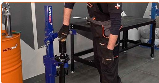
**40** Installieren Sie die Feder am Stoßdämpfer.
