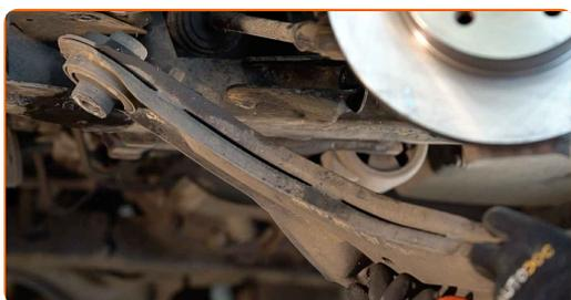
17 Reinigen Sie die Montagebohrungen und die Gewinde des Querlenkers. Benutzen Sie eine Drahtbürste. Benutzen Sie WD-40-Spray.
