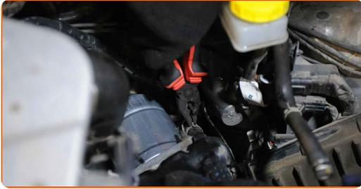
**24** Ziehen Sie die Befestigungsklemme der Kraftstofffilterleitung an. Verwenden Sie Zangen.
