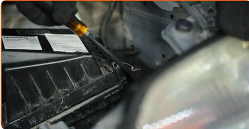
**30** Sichern Sie das Befestigungselement des Luftansaugkanals. Verwenden Sie einen flachen Schraubendreher.
