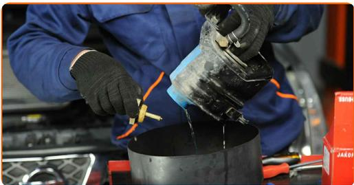
**15** Entfernen Sie den Kraftstofffilter.
