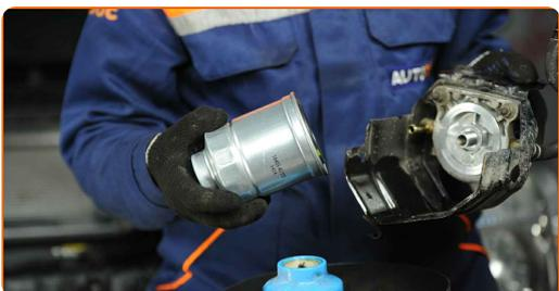
**17** Reinigen Sie die Abdeckung und das Gehäuse des Kraftstofffilters. Verwenden Sie Allzweckreinigungsspray.
