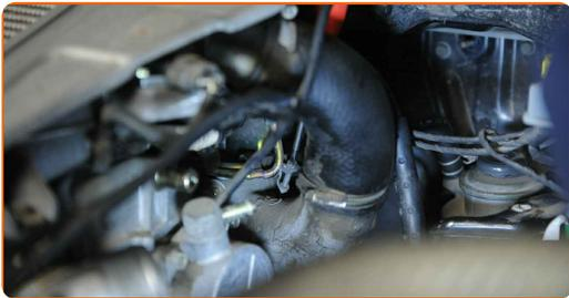
**25** Schrauben Sie die Befestigungsbolzen der Treibstofffilterhalterung an. Verwenden Sie Stecknuss Nr. 10. Verwenden Sie einen Ratschenschlüssel. Verwenden Sie einen Kreuzschlitzschraubendreher.
