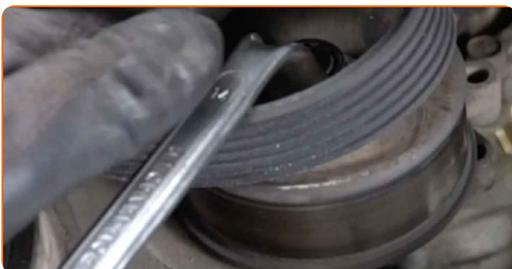
**13** Setzen Sie den Keilrippenriemen auf die Spannrolle auf.
