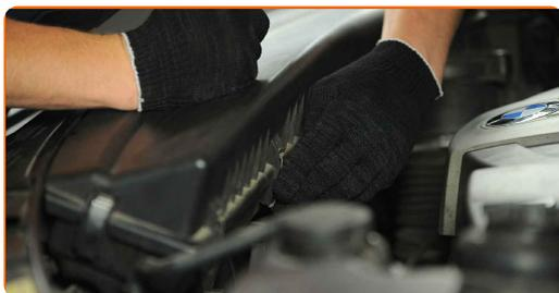
**13** Schrauben Sie die Klemme, die den Luftfilterschlauch mit der Drosselklappe verbindet, ein. Verwenden Sie einen flachen Schraubendreher.
