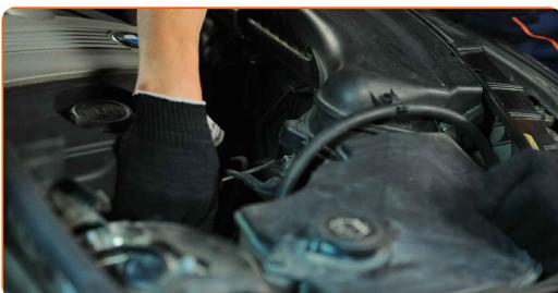
**4** Ziehen Sie den Stecker des Luftmassenmessers ab. Verwenden Sie einen flachen Schraubendreher.
