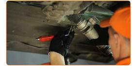
Entfernen Sie den Kraftstofffilter.
