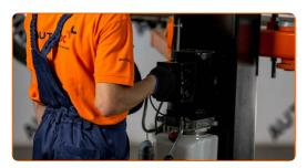
Lösen Sie die Halterung des Kraftstofffilters. Verwenden Sie Stecknuss Nr. 10. Verwenden Sie einen Ratschenschlüssel.
