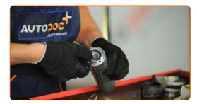
Befestigen Sie den Kraftstofffilter am Halter. 11
