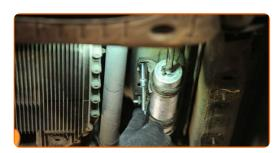
Schrauben Sie den Befestigungssitz des Kraftstofffilters ein. Verwenden Sie Stecknuss Nr. 10. Verwenden Sie einen Ratschenschlüssel.
