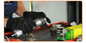
Schrauben Sie die Halterung des Kraftstofffilters ein. Verwenden Sie den Torx T20. Verwenden Sie einen Ratschenschlüssel. Verwenden Sie einen flachen Schraubendreher.
