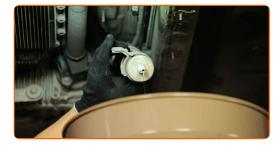
Entfernen Sie die Federklemme, die die Kraftstoffleitung fixiert. Verwenden Sie einen flachen Schraubendreher.
