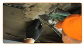
Befestigen Sie die Leitung am Kraftstofffilter.
