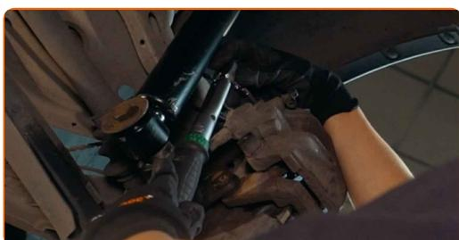
**22** Installieren Sie die Staubschutzkappen der Bremssattel-Führungsstifte.
