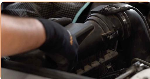
11 Verbinden Sie das Luftansaugrohr mit dem Luftfilter-Gehäuse.
