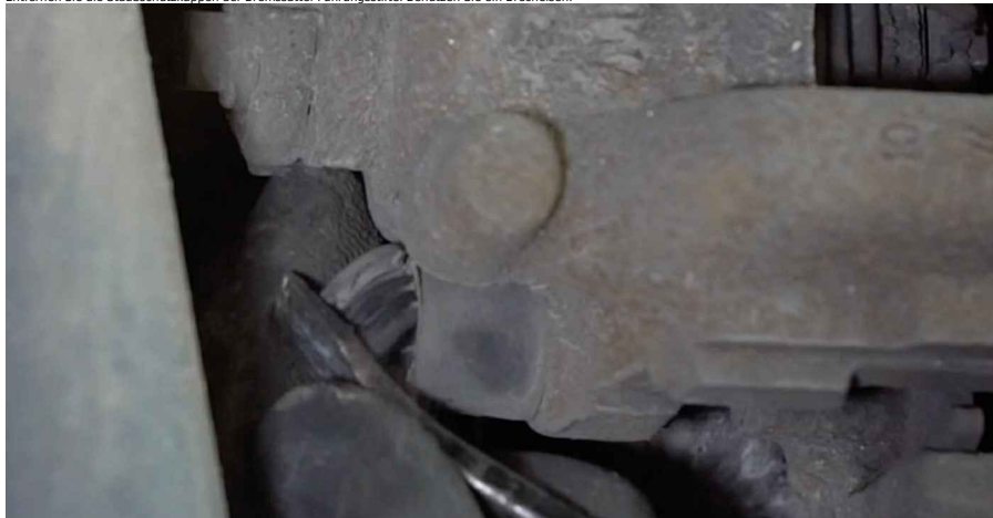
12 Schrauben Sie die Befestigung des Bremssattels ab. Verwenden Sie Inbuschlüssel Nr. H7. Verwenden Sie einen Ratschenschlüssel.
