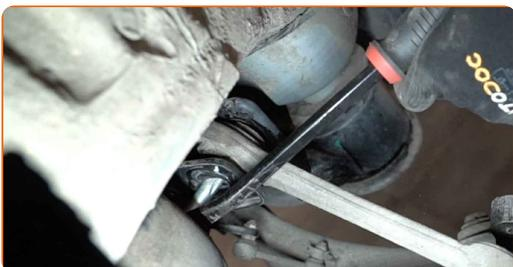
**11** Entfernen Sie das Kugelgelenk vom Achsschenkel.
