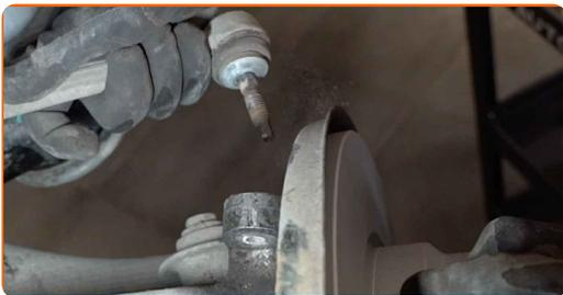
**12** Entfernen Sie den hinteren Oberarm. Benutzen Sie ein Brecheisen.
