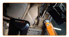
Schrauben Sie den Ölfilter ab. Verwenden Sie Steckschlüssel 65-14F. Verwenden Sie einen Ratschenschlüssel.
