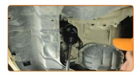
Drehen Sie die Ablassschraube heraus. Verwenden Sie Ring-Gabelschlüssel Nr. 14.
