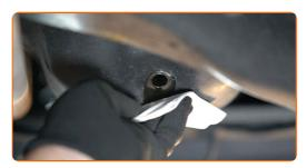
Schrauben Sie die neue Ablassschraube ein und ziehen Sie sie fest. Verwenden Sie Ring-Gabelschlüssel Nr. 14. Verwenden Sie einen Drehmomentschlüssel. Ziehen Sie ihn mit 25 Nm Drehmoment fest.
