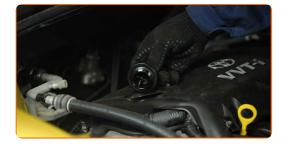
15 Entfernen Sie die Öleinfüllschraube.
