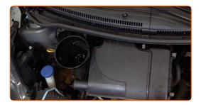
Füllen Sie Öl durch den Einfüllstutzen in den Motor. Erforderliche Menge an Öl: 3.5 l.
