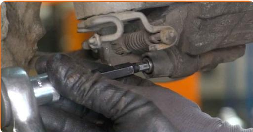
**30** Installieren Sie die Staubschutzkappen der Bremssattel-Führungsstifte.
