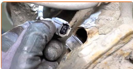
**19** Reinigen Sie das Befestigungselement der Radnabe. Benutzen Sie eine Drahtbürste. Benutzen Sie WD-40-Spray.
