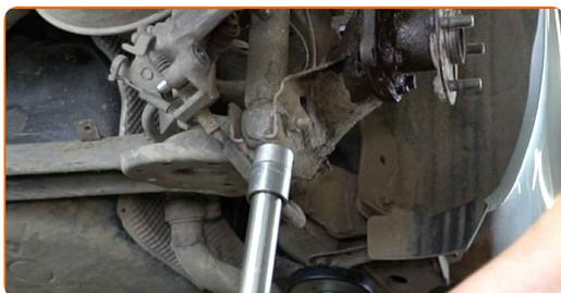
**21** Schrauben Sie die Befestigungen des Radnabenlagers ab. Verwenden Sie Stecknuss Nr. 14. Verwenden Sie einen Ratschenschlüssel.
