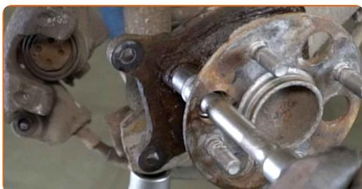
**22** Entfernen Sie die Befestigungsschrauben.
