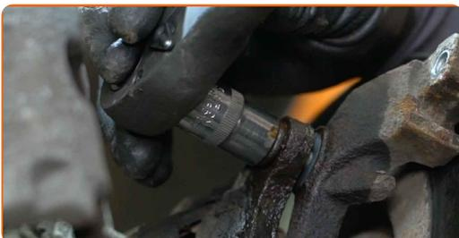
**14** Entfernen Sie die Befestigungsschrauben.
