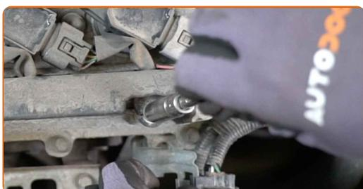
**9** Entfernen Sie die Befestigungsschrauben.
