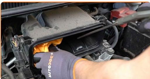
**34** Entfernen Sie das Mikrofaser Tuch vom Luftansaugschlauch.
