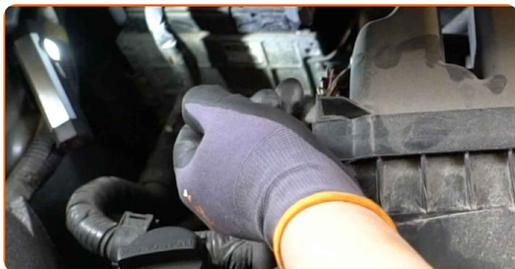
4 Trennen Sie das Luftansaugrohr vom Luftfilter-Gehäuse.
