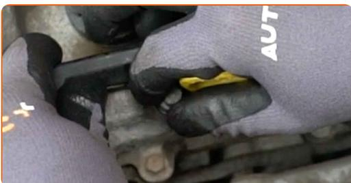
**32** Ziehen Sie die Befestigungen der Halterung des Kabelbaums an. Verwenden Sie Stecknuss Nr. 10. Verwenden Sie einen Drehmomentschlüssel. Ziehen Sie ihn mit 9 Nm Drehmoment fest.
