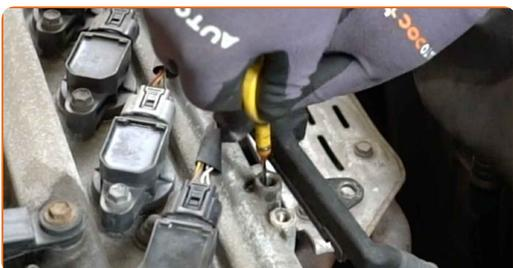
**13** Lösen Sie die Steckverbindung von den Zündspulen.
