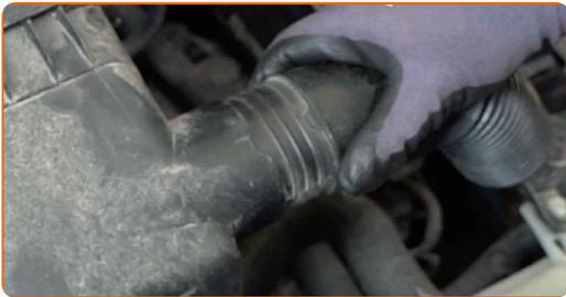
**36** Setzen Sie die Luftfilterabdeckung ein. Befestigen Sie diese.
