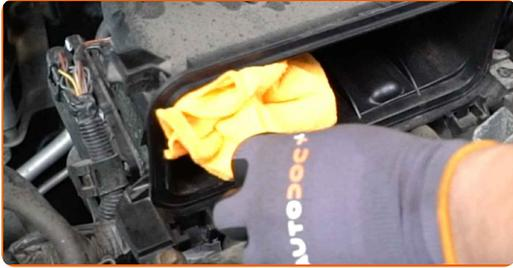
**35** Verbinden Sie das Luftansaugrohr mit dem Luftfilter-Gehäuse.
