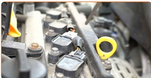
8 Schrauben Sie die Befestigungen der Halterung des Kabelbaums ab. Verwenden Sie Stecknuss Nr. 10. Verwenden Sie einen Ratschenschlüssel.
