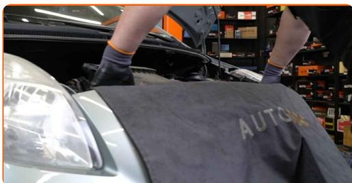
**3** Lösen Sie die Befestigungsclips der Luftfilterabdeckung.
