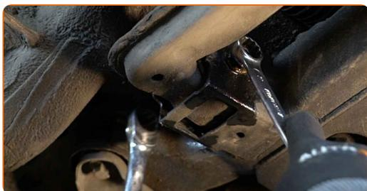
**11** Lösen Sie die hintere Befestigung des Querlenkers.
