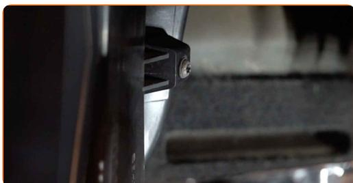
**12** Entfernen Sie den Gehäusedeckel des Innenraumfilters.
