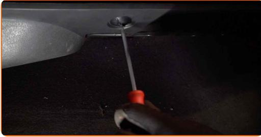
**24** Schrauben Sie die Befestigungen der Einstiegsverkleidung im Fahrgastbereich ein. Verwenden Sie einen flachen Schraubendreher.
