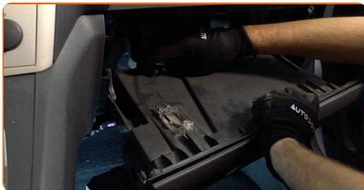
**9** Entfernen Sie die Befestigungen des Luftkanal-Gehäuses.
