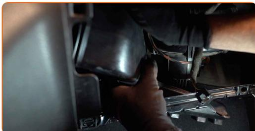
**11** Schrauben Sie die Verbindungselemente der Innenfilter-Gehäuseabdeckung ab. Verwenden Sie den Torx T20.
