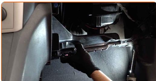
**18** Bringen Sie die Befestigungen des Luftkanal-Gehäuses an.
