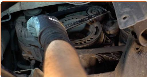
**12** Setzen Sie den Keilrippenriemen auf die Spannrolle auf.
