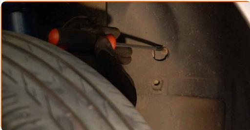
6 Entfernen Sie die Radkastenabdeckung.
