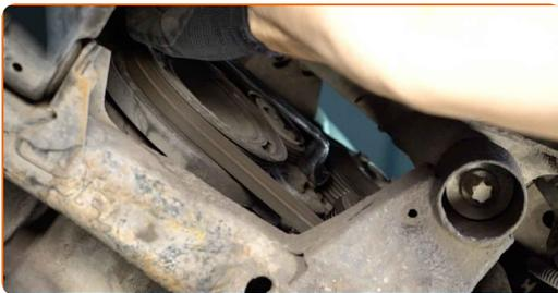
8 Entfernen Sie den Keilrippenriemen.
