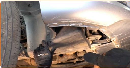
**15** Bringen Sie die Befestigungselemente der Radkastenabdeckung an und ziehen Sie diese an. Verwenden Sie den Torx T25.
