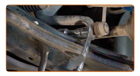
Schrauben Sie das Befestigungselement heraus, das die Druckstange mit dem Federbein verbindet. Verwenden Sie Ring-Gabelschlüssel Nr. 19. Verwenden Sie Stecknuss Nr. 19. Verwenden Sie einen Ratschenschlüssel.
