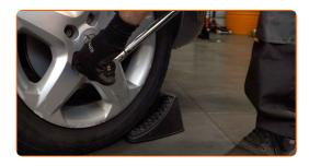
Entfernen Sie den Wagenheber sowie die Unterlegkeile.
