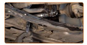
Ziehen Sie das Befestigungselement an, das die Druckstange mit dem Federbein verbindet. Verwenden Sie Stecknuss Nr. 19. Verwenden Sie einen Drehmomentschlüssel. Ziehen Sie ihn mit 55 Nm Drehmoment fest.
