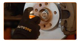
Die Bremsscheibenoberfläche reinigen. Benutzen Sie einen Bremsenreiniger.
