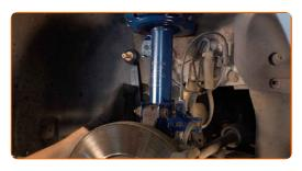
Ziehen Sie das Befestigungselement an, das die Druckstange mit dem Stabilisator verbindet. Verwenden Sie Stecknuss Nr. 19. Verwenden Sie einen Drehmomentschlüssel. Ziehen Sie ihn mit 55 Nm Drehmoment fest.
