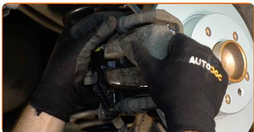
**22** Ziehen Sie die Bremssattelbefestigungen fest. Verwenden Sie Ring-Gabelschlüssel Nr. 17. Verwenden Sie Stecknuss Nr. 13. Verwenden Sie einen Drehmomentschlüssel. Ziehen Sie ihn mit 25 Nm Drehmoment fest.
