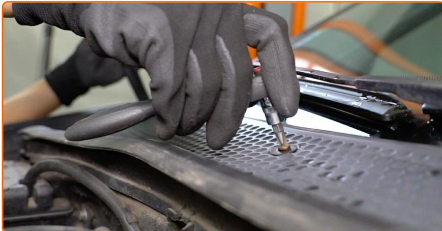
Schrauben Sie das Befestigungselement der Windlaufabdeckung heraus, die sich an der rechten Seite befindet. Verwenden Sie einen Kreuzschlitzschraubendreher.
