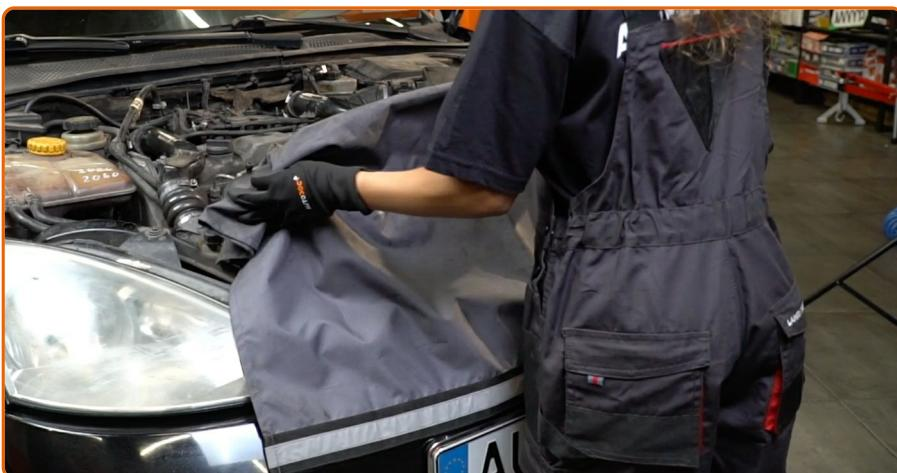
Entfernen Sie die Kotflügel-Abdeckung.
