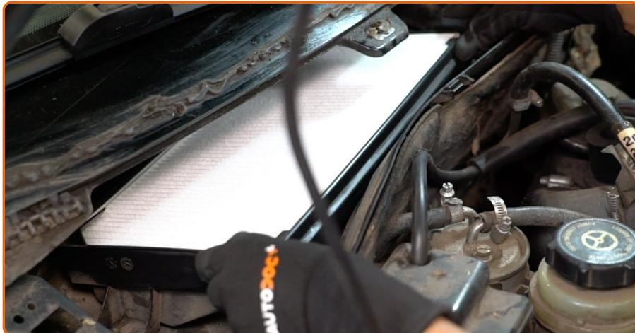
Installieren Sie den Kabinenfilter an seinem Montagesitz.
