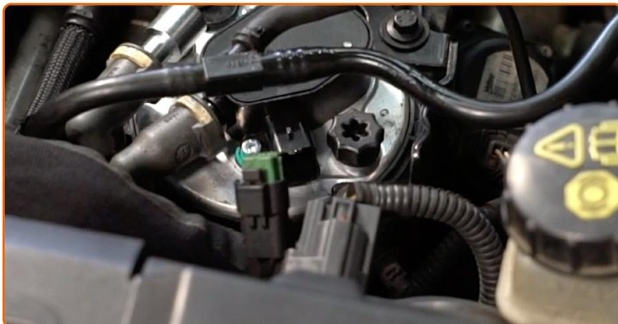
Trennen Sie den Anschluss des Kraftstoffdrucksensors. Verwenden Sie einen flachen Schraubendreher.
