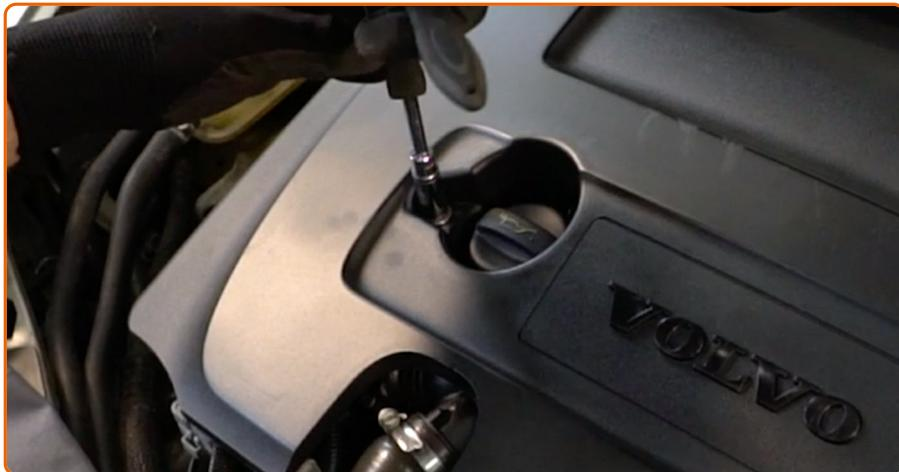
Schrauben Sie das Verbindungsteil der Motorhaube ab. Verwenden Sie Stecknuss Nr. 10.
