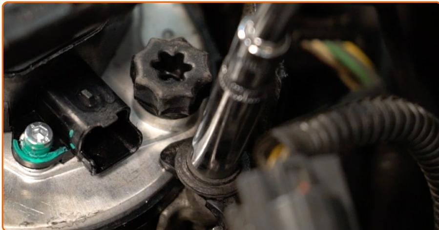
Schrauben Sie die Befestigungsbolzen der Treibstofffilterhalterung ab. Verwenden Sie Stecknuss Nr. 8. Verwenden Sie einen Ratschenschlüssel.
