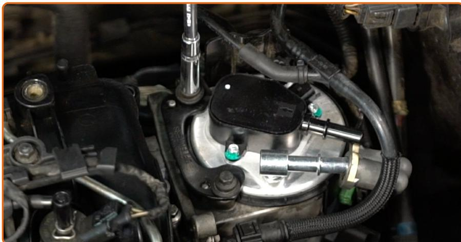
Schrauben Sie die Befestigungsbolzen der Treibstofffilterhalterung an. Verwenden Sie Stecknuss Nr. 8. Verwenden Sie einen Ratschenschlüssel.
