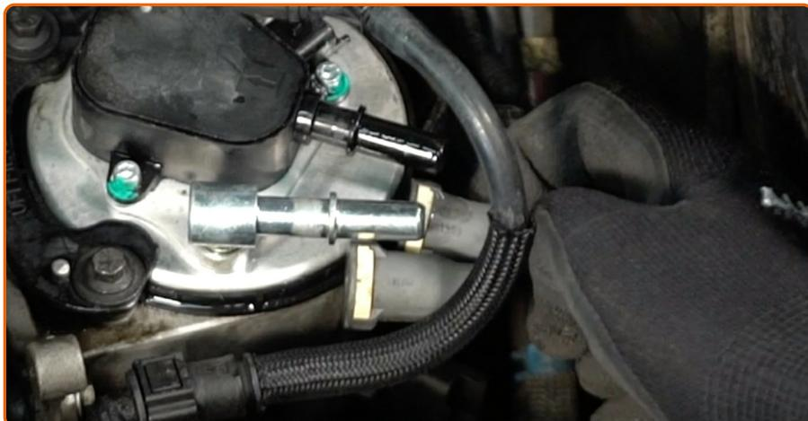
Drücken Sie die Clips zusammen und lösen Sie die Kraftstoffzuführleitungen vom Kraftstofffiltergehäuse.
