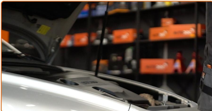
Öffnen Sie die Haube. Verwenden Sie eine Kotflügel-Schutzabdeckung, um Schäden an der Lackierung und den Kunststoffteilen des Autos zu verhindern.
