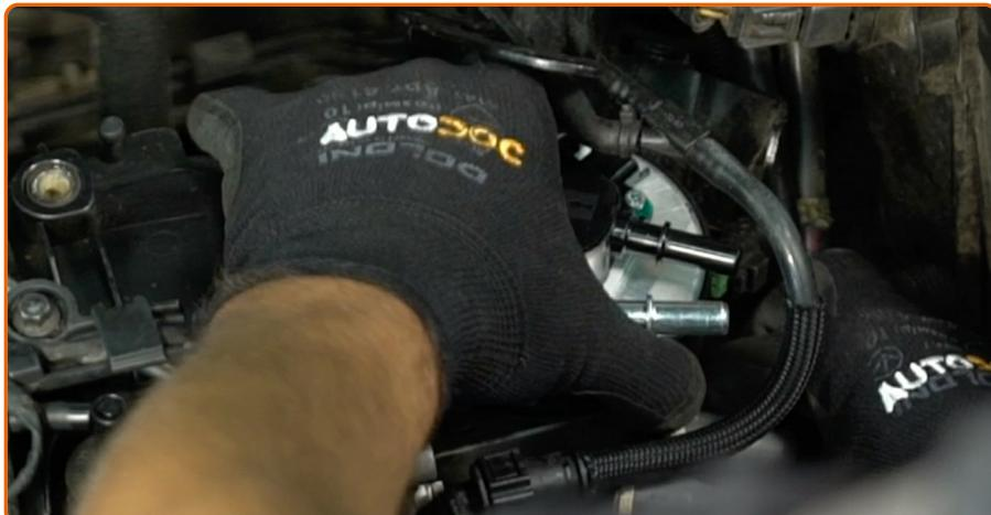
Installieren Sie einen neuen Kraftstofffilter.
