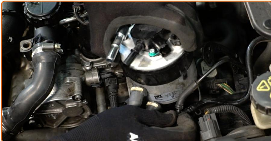
Entfernen Sie den Kraftstofffilter.
