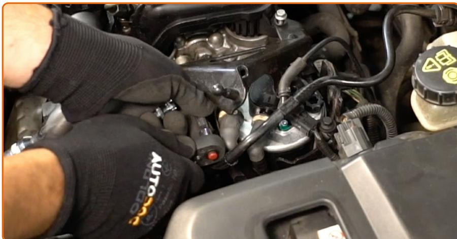
Schrauben Sie die Befestigungsbolzen der Treibstofffilterhalterung an. Verwenden Sie Stecknuss Nr. 8. Verwenden Sie Stecknuss Nr. 10. Verwenden Sie einen Ratschenschlüssel.
