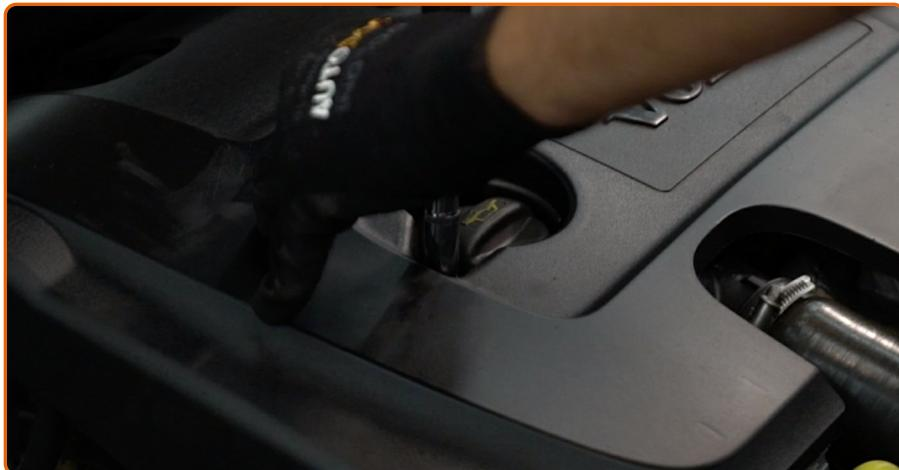
Schrauben Sie die Verbindungsgelemente der Motorhaube ein. Verwenden Sie Stecknuss Nr. 10.
