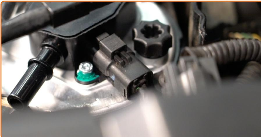
Bringen Sie den Anschluss des Kraftstoffdrucksensors an.
