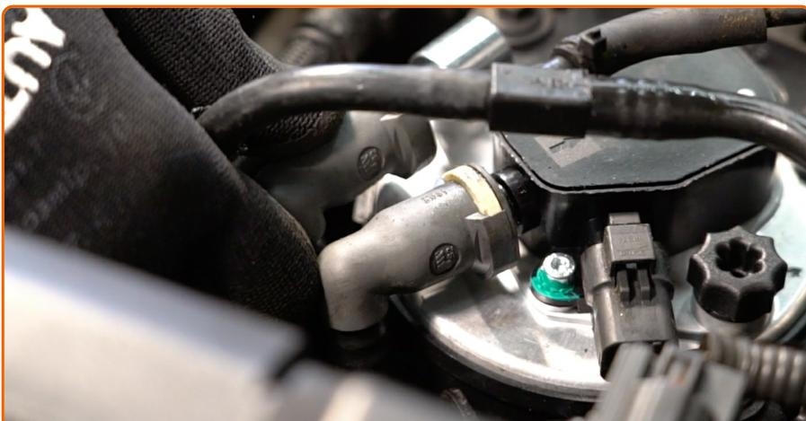
Verbinden Sie die Kraftstoffversorgungsleitungen zum Kraftstofffilter.
