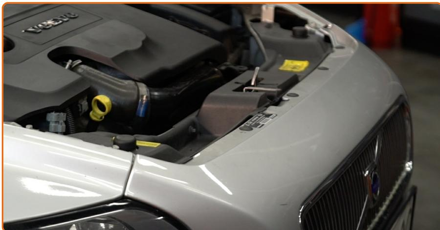
Entfernen Sie die Kotflügel-Abdeckung.
