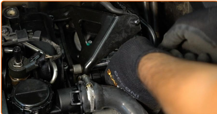
Schrauben Sie die Befestigungsbolzen der Treibstofffilterhalterung ab. Verwenden Sie Stecknuss Nr. 8. Verwenden Sie Stecknuss Nr. 10. Verwenden Sie einen Ratschenschlüssel.
