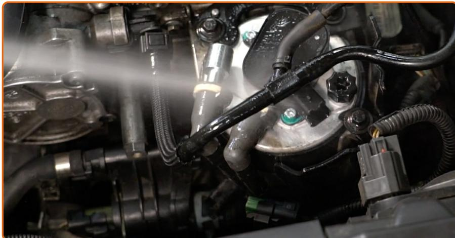
Reinigen Sie den Kraftstofffilter. Verwenden Sie Allzweckreinigungsspray.
