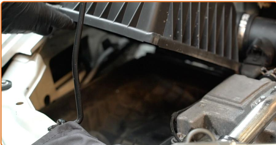
Entfernen Sie das Mikrofasertuch vom Luftansaugschlauch.
