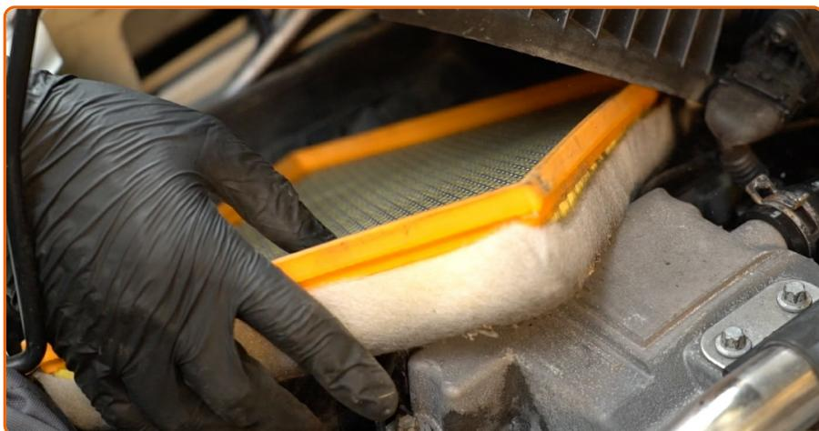
Entfernen Sie das Filterelement aus dem Filtergehäuse.
