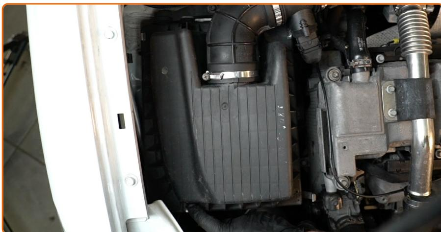
Lösen Sie die Befestigungsclips der Luftfilterabdeckung.
